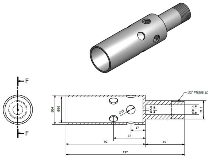
155. Было проведено целевое исследование для разработки таких технических характеристик газовой горелки (СНГ), которые – по температуре пламени и удельному тепловому потоку – были бы эквивалентны типичному пламени при разливе горящего бензина.
