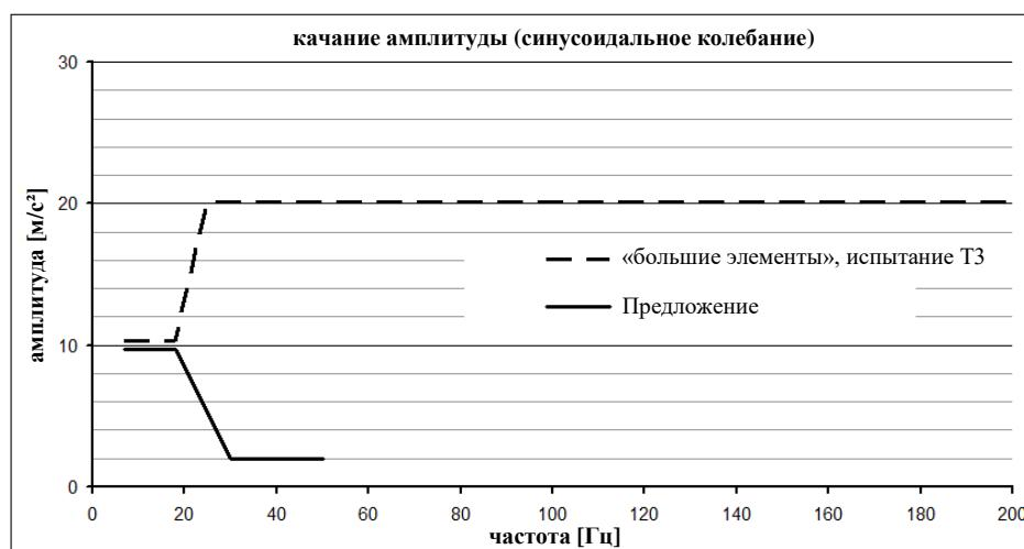
135. Продолжительность испытания также приведена в соответствие с испытанием Т3: требуется 12 переходов с минимальной частоты к максимальной и обратно в течение 15 мин, в результате чего общая продолжительность испытания составляет 3 часа.
