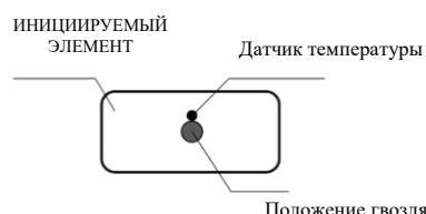
*Примечание:* При испытании на избыточную зарядку датчик температуры размещают на поверхности топливного элемента на равном удалении от обеих клемм аккумуляторной батареи и как можно ближе к ним.
