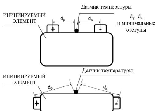
*Примечание:* При схеме испытания с использованием нагревателя датчик температуры устанавливают на дальней стороне теплопроводности, например противоположно тому месту, где размещен нагреватель (см. рис. 3). Если применить датчик температуры напрямую представляется затруднительным, то его устанавливают в том месте, где можно зафиксировать постоянное повышение температуры в инициируемом топливном элементе.
