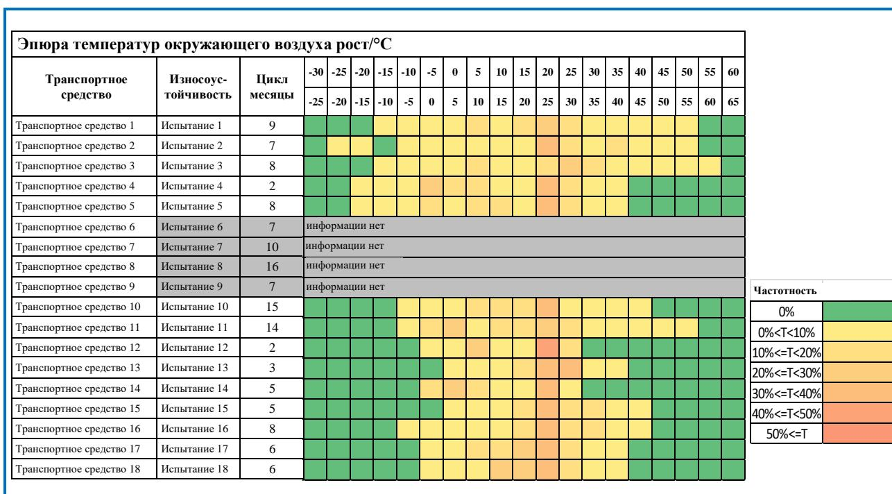
148. Исходя из указанных результатов, в реальных условиях сценарием, характеризующимся наибольшими перепадами температуры, является следующий: парковка транспортного средства на открытой стоянке (возможно, на ночь) при температуре  $-40^{\circ}\text{C}$ , запуск двигателя и нагревание аккумуляторной батареи в процессе эксплуатации до максимальной температуры  $60^{\circ}\text{C}$ .
