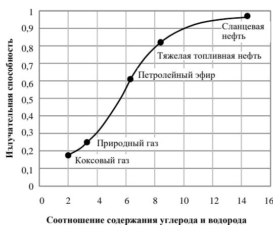
157. Даже при использовании одного и того же топлива и относительного положения предмета, охватываемого пламенем, тепловой поток не может быть одинаковым, кроме случаев, когда факел пламени также эквивалентен. Таким образом, для получения одинакового удельного теплового потока следует надлежащим образом контролировать факел пламени.
