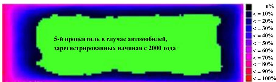
212. Размеры ограниченных монтажных зон для обобщенно официально утвержденной ПЭАС взяты из Приложения 111 японского стандарта (технический стандарт на защиту водителя и пассажиров электромобилей и гибридных электрических транспортных средств от высокого напряжения после столкновения). Этим стандартом запрещается установка ПЭАС в пределах 420 мм в направлении от передней части транспортного средства назад и 300 мм в направлении от задней части транспортного средства вперед (см. рис. 25).
