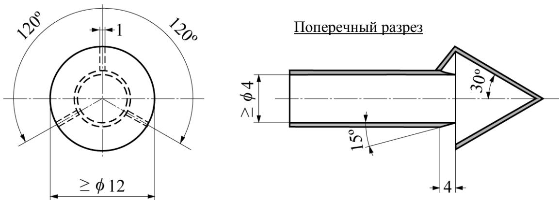
Рис. 9.3 – Схема пробоотборника с конусообразным предварительным сепаратором
