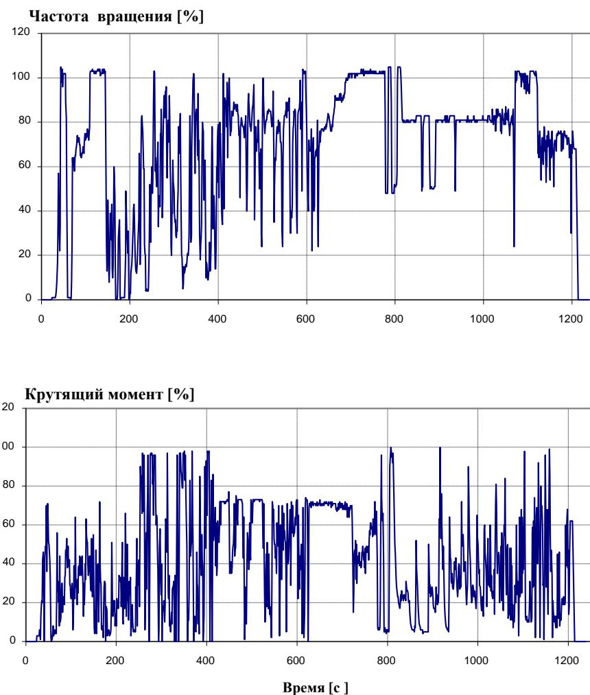
Рис. 7.2 - Приведенная динамометрическая программа ПЦИВ
