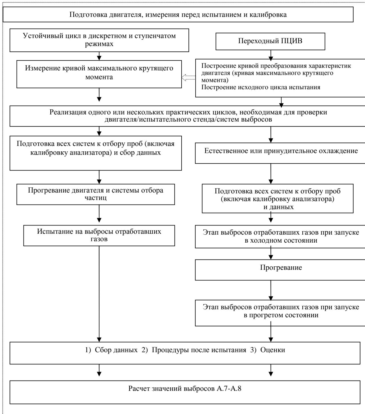
Рис. 7.3 – Последовательность испытания
