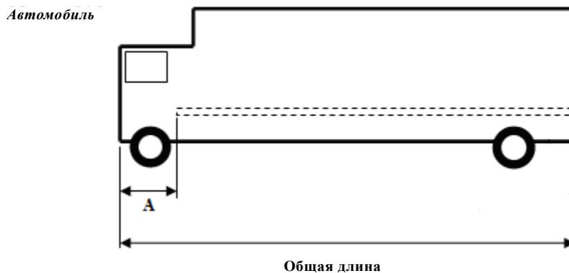
A – расстояние между наиболее выступающей частью маркировки и передним краем транспортного средства. Максимальное значение A составляет 2 400 мм (см. пункт 6.21.4.2.1.1)".
