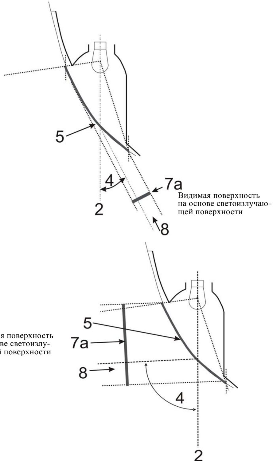
**Часть 5 – Пример освещающей поверхности в сопоставлении со светоизлучающей поверхностью в случае "огня с единой функцией"**
