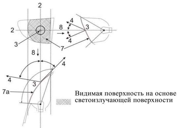
**Часть 2 – Освещаящая поверхность устройства световой сигнализации, не являющегося светоотражателем**
