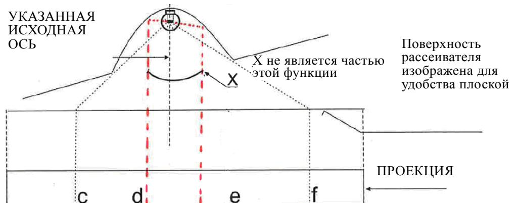
Указанная светоизлучающая поверхность в соответствии с пунктом 2.8.a)
