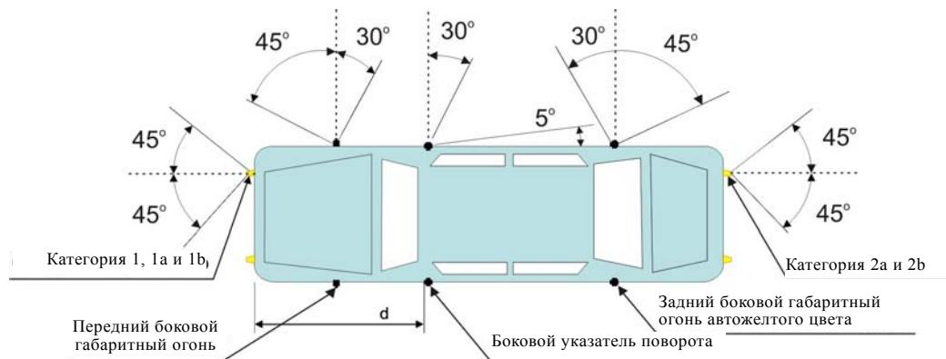
Угол  $45^\circ$  внутрь для указателей поворота категорий 1, 1а или 1б, у которых нижний край видимой поверхности находится на высоте менее 750 мм над уровнем грунта, может быть уменьшен до  $20^\circ$  вниз от горизонтальной плоскости, через которую проходит исходная ось этого огня.
