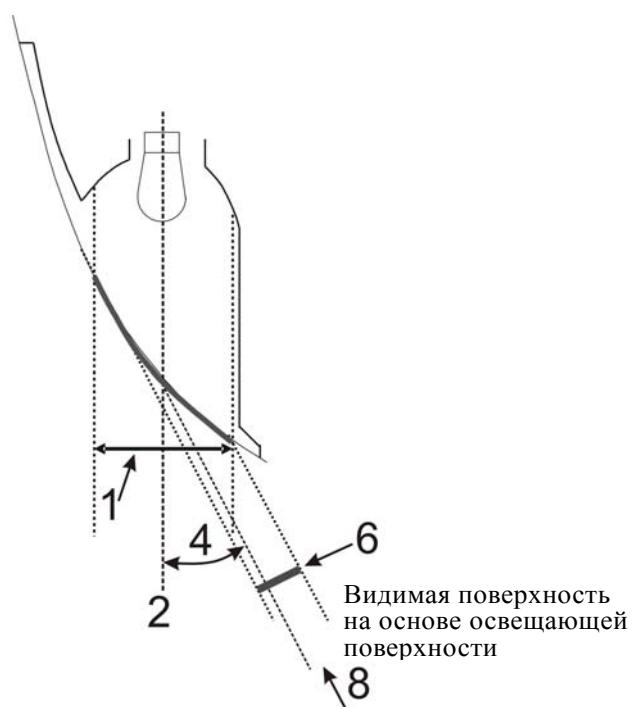
**Часть 4 – Примеры видимой поверхности на основе светоизлучающей поверхности в различных направлениях геометрической видимости**
