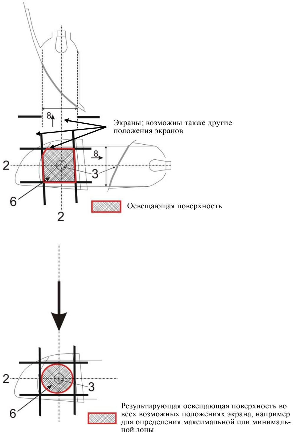
**Часть 3 – Примеры видимой поверхности на основе освещющей поверхности в различных направлениях геометрической видимости**
