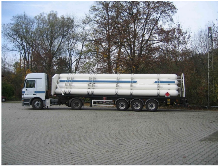
Транспортное средство-батарея, сконструированное с использованием бесшовных стальных трубок
