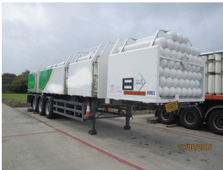
Транспортное средство-батарея, сконструированное с использованием бесшовных стальных баллонов
