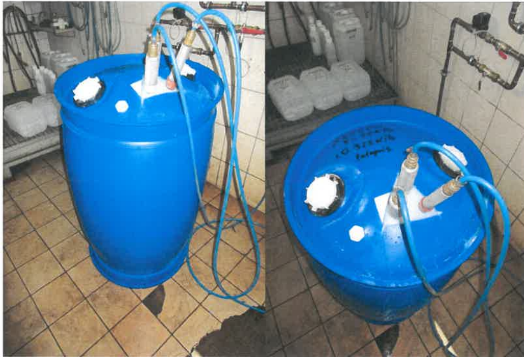
Hydraulische Innendruckprüfung / internal pressure (hydraulic) test
