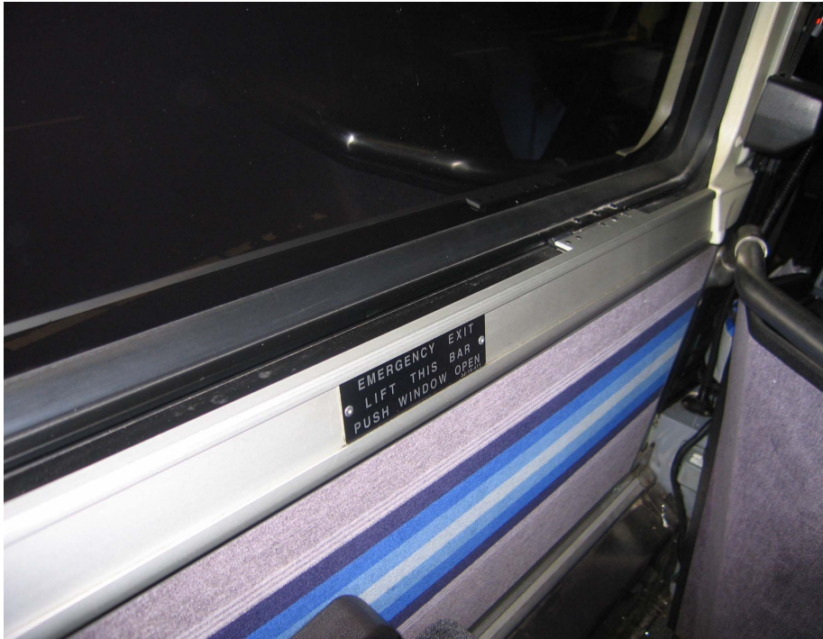
Рис.2 Запасный выход раздвижного типа в виде части окна (окно целиком склеено с оконной рамой, и его элемент используется в качестве запасного выхода раздвижного типа)
