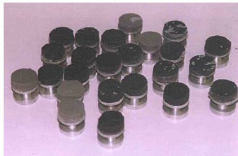
Exemple de pions avec la couche de polyuréthane extraite.
