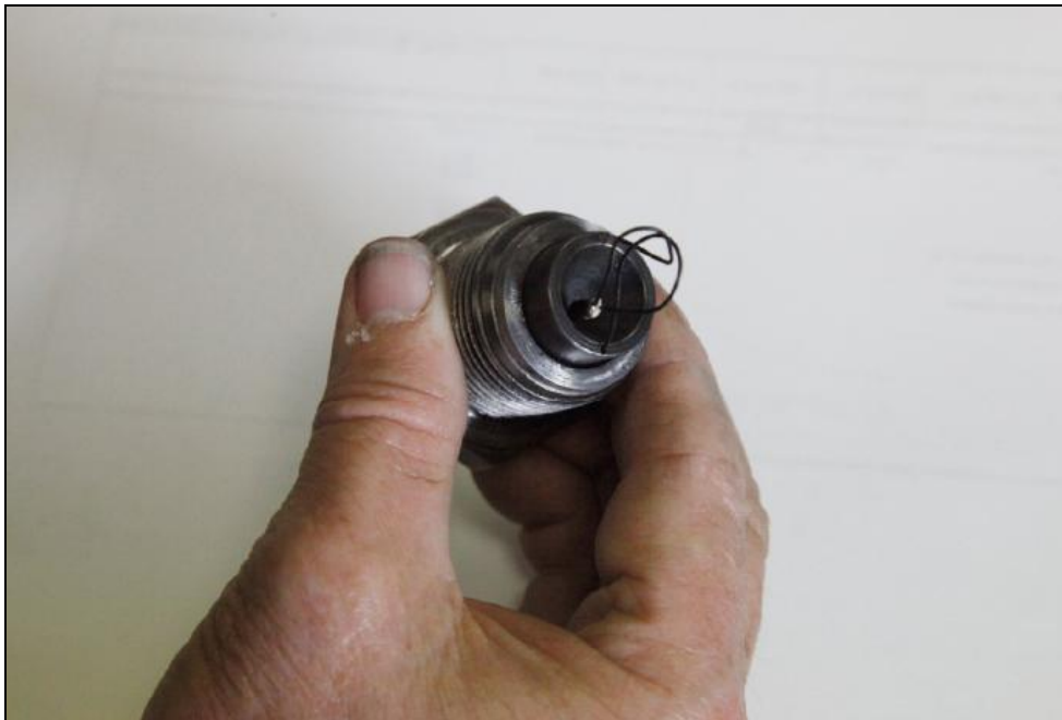
Bouchon de mise à feu modifié avec l'allumeur électrique replié
