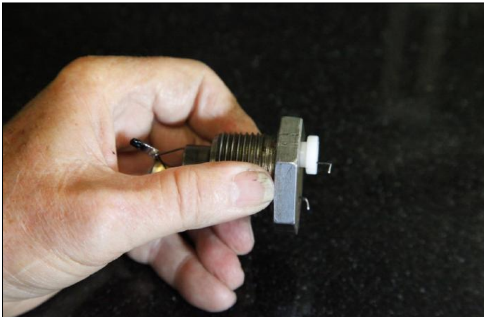
Figure 11 Fils de l'allumeur électrique-extrémités recourbées
