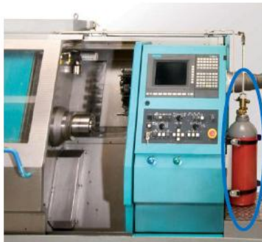
Figures 4 et 5: Bouteilles à gaz utilisées dans les installations fixes de lutte contre l'incendie
