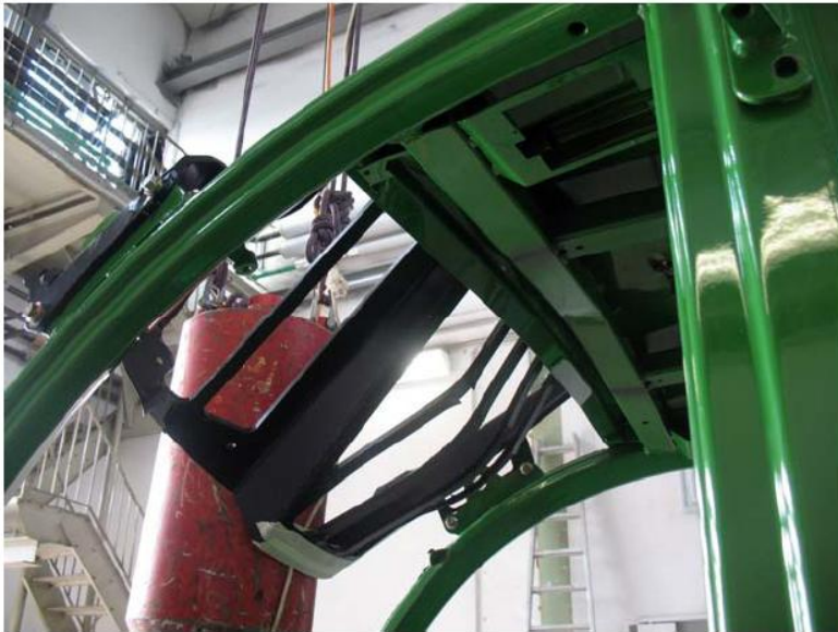
Nach dem Auftreffen des Fallkörpers auf das FOPS-Gitter- Ansicht von der Unterseite (After the drop of the falling object on the FOPS-grid – view from down side)
