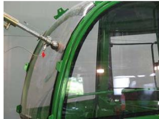
Belastung der Scheibenmitte bei Testende (loading of the centre at end of test)
