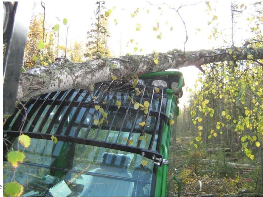
Nach dem Auftreffen des Fallkörpers auf das FOPS-Gitter- Ansicht von der Unterseite (After the drop of the falling object on the FOPS-grid – view from down side)
