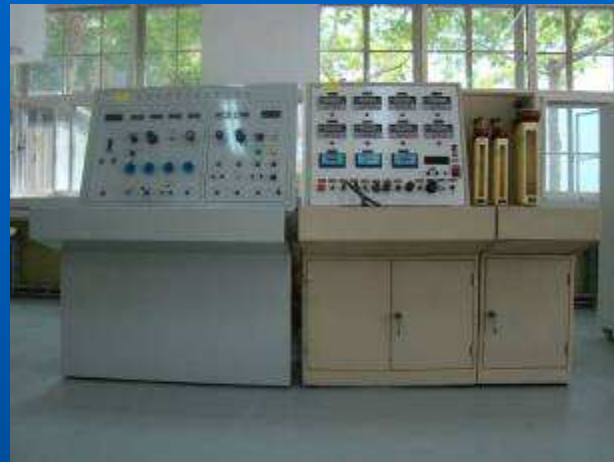
高压燃气附件试验台
