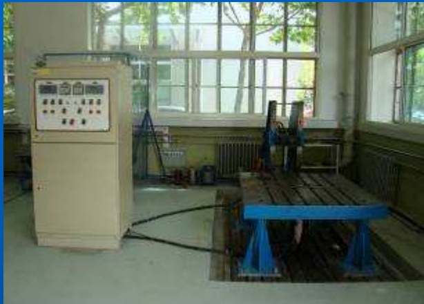
气瓶电堆安装强度试验台
