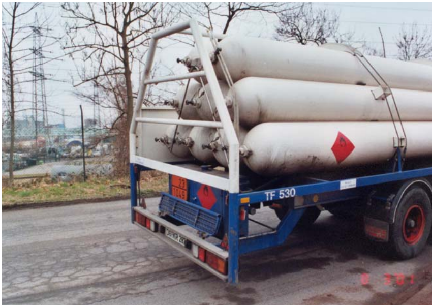
Photo 1 :véhicule-batteries avant l'accident, vu de l'arrière avec grillage arrière en tuyaux
