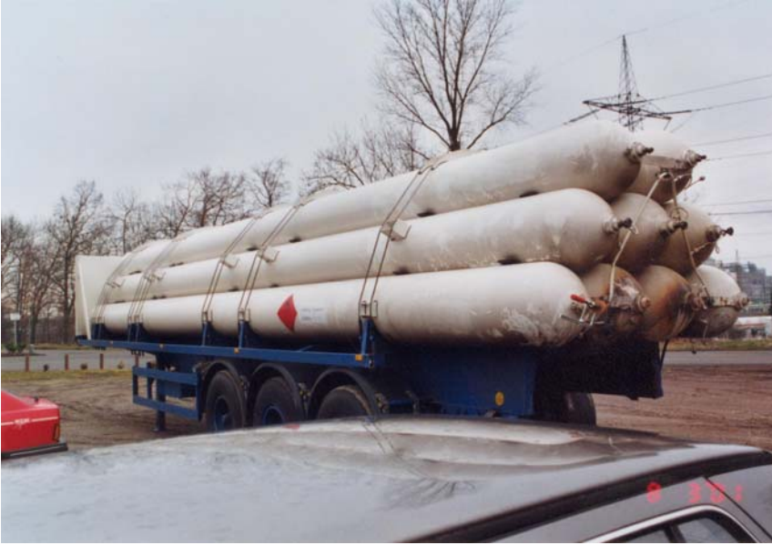
Photo 2 : véhicule-batteries après la collision par un véhicule routier à environ 60 km/h.
