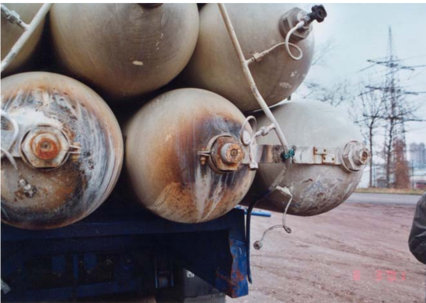
Photo 3 : vue détaillée du véhicule-batterie après l'accident : premiers obturateurs (soupapes en laiton) rompus, traces d'incendie des flammes d'hydrogène.
