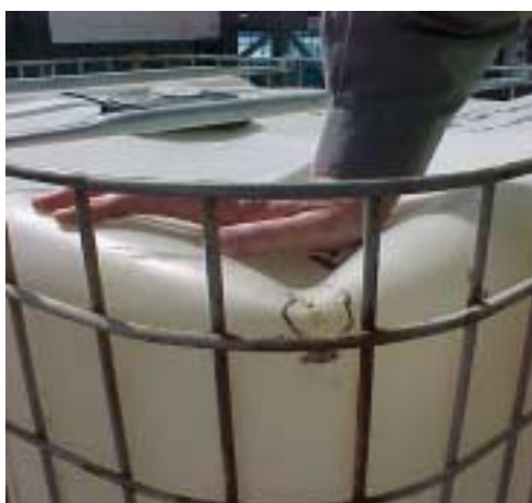
Écrasement de l'emballage intérieur alors que l'armature et les traverses sont restées intactes. Ce GRV a été qualifié de réutilisable, sans restriction aucune.
