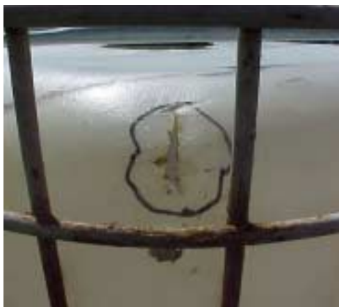
Endommagement du coin du GRV (à travers l'armature extérieure restée intacte) dû à l'entrée en contact de la palette-embase supérieure avec l'emballage intérieur en plastique rigide.
