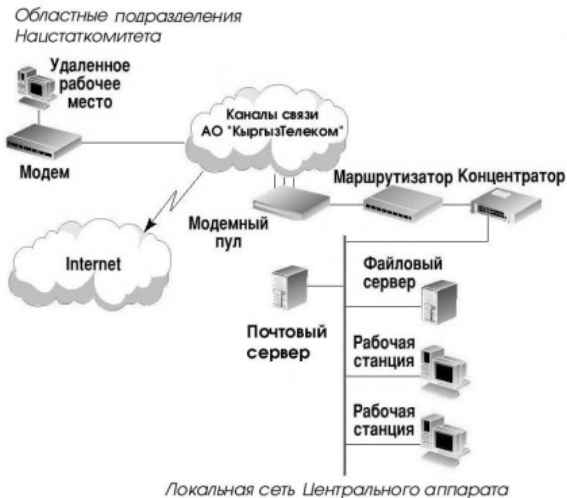
Рис.2 Доставка электронной почты по коммутируемым каналам связи.
