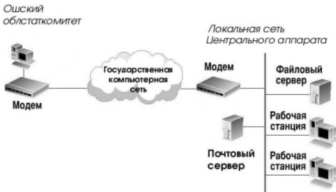
Рис.1 Доставка электронной почты по выделенным каналам связи
