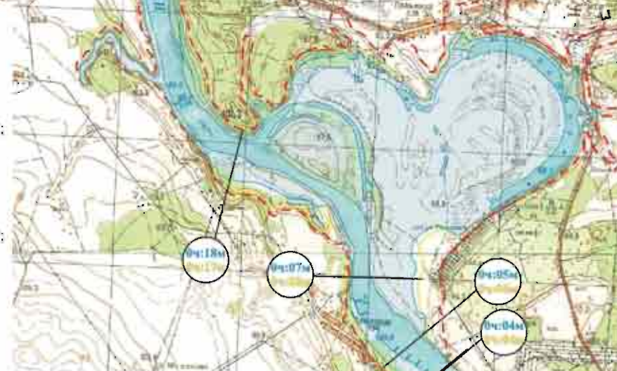
Схема вероятных затоплений при прорыве плотины водохранилища Немновской ГЭС при среднемеженных расходах воды 50% ВП
