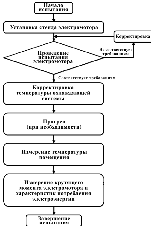
Рис. 36 Схема процедуры испытания электродвигателя
