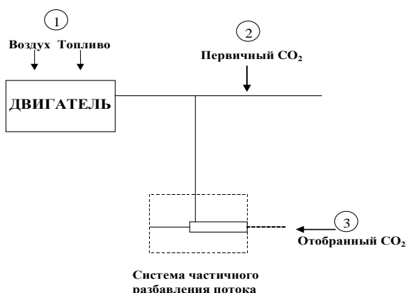
Рис. 18 Точки замера для проверки расхода углерода
