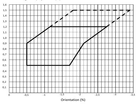
La zone située à l'intérieur de la ligne discontinue indique l'extension du diagramme de visée, valable uniquement pour les véhicules des catégories  $M_2G$ ,  $M_3G$ ,  $N_2G$  et  $N_3G$  (véhicules tout-terrain). ».
