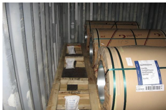
Рис. 7.40 Блокировка у ограничивающих конструкций
