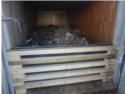
Рис. 7.5576 Загруженный ломом ГТЕ с облицовкой стен и барьером у дверей контейнер с облицовкой
