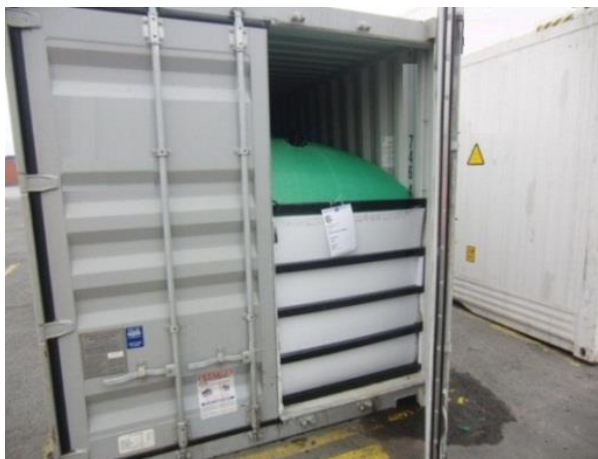
Рис. 7.54-67 Контейнер с установленным внутри мягким танк-контейнером
