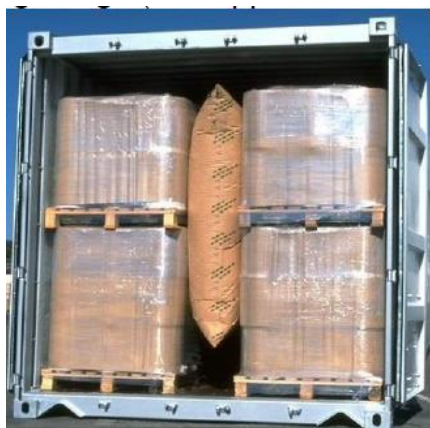
Рис. 7.912 Заполнение пустоты по центру с помощью пневмооболочки
