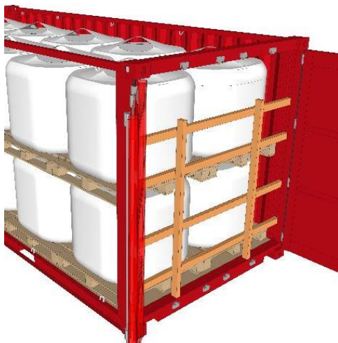
Рис. 7.49 Брусья для подпорки, вставленные в соответствующие ниши и поддерживаемые вертикальными брусьями, установленными напротив дверей
