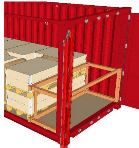
Рис. 50 Поперечные балки, вставленные в гофры и поддерживаемые подпорными балками у дверных петель
