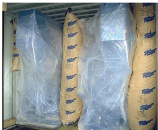
Рис. 7.913 Блокировка пневмооболочками упаковок неправильной формы без острых кромок
