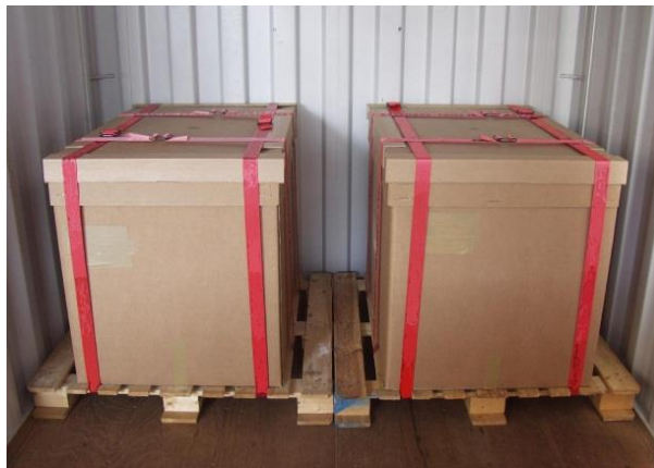
Рис. 7.811 Груз, прочно закрепленный на поддонах найтовыми из текстиля
