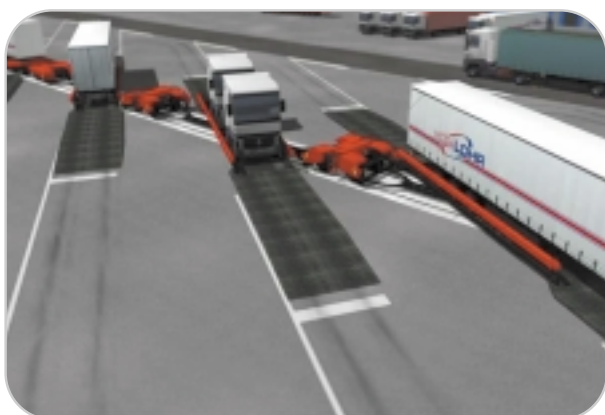
Après décrochage des semi-remorques, chargement des tracteurs sur la plate-forme adjacente
