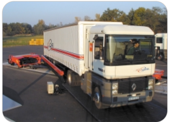
Le camion traverse la plate-forme jusqu'à ce que le tracteur ressorte de l'autre côté
