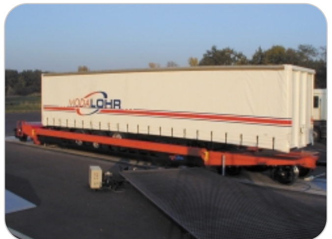
Fermeture du wagon grâce au système au sol, puis verrouillage du wagon ; le wagon est alors prêt au départ
