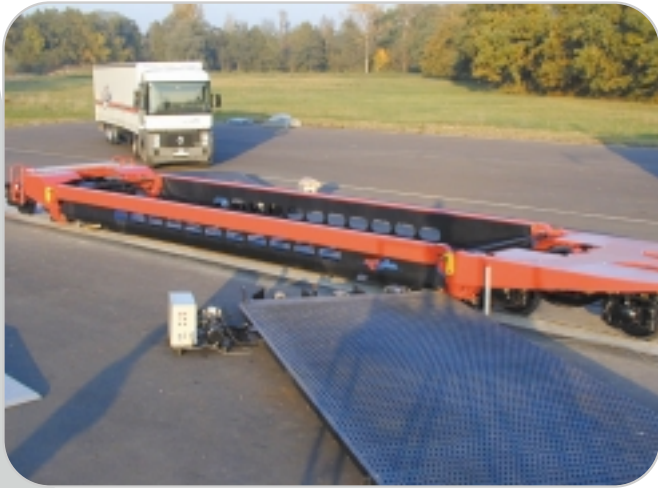
Arrêt du wagon par rapport au système au sol, puis déverrouillage de la plate-forme surbaissée
