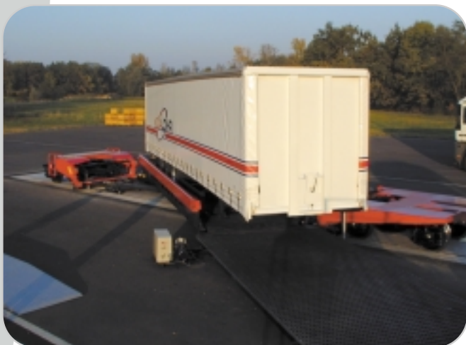
Après décrochage, le tracteur se charge sur la plate-forme adjacente si le camion complet voyage sur le train, ou bien le tracteur quitte le terminal si la semi-remorque voyage seule
