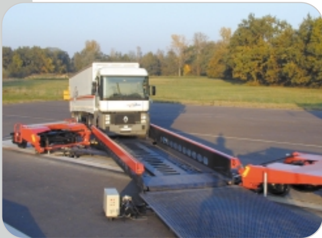
Le camion se charge sur le wagon en avançant simplement en ligne droite
