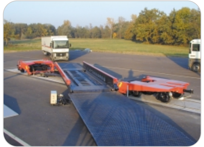
Rotation de la plate-forme surbaissée grâce au système d'ouverture au sol
