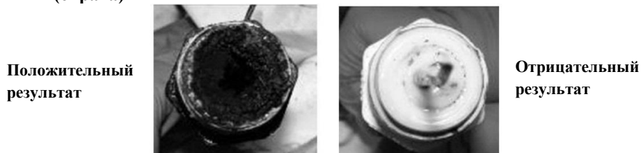
Рис. 18.8.3 Типичный вид испытательной камеры после получения положительного результата (слева) или отрицательного результата (справа)
