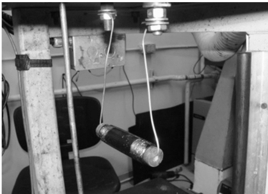
Рис. 18.8.2 Испытательная камера, установленная горизонтально под крышкой сосуда (медные провода подсоединены к стационарным электродам сосуда)
