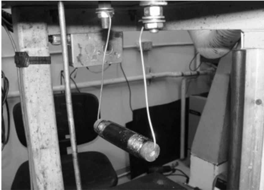
Figure 18.8.2 Chambre d'épreuve montée horizontalement sous le capot de la bombe (conducteurs en cuivre reliés aux électrodes fixes de la bombe)
