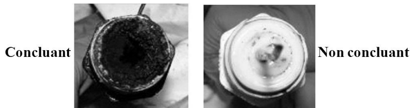
Figure 18.8.3 Apparence typique d'une chambre d'épreuve après un essai concluant (à gauche) ou non concluant (à droite)
