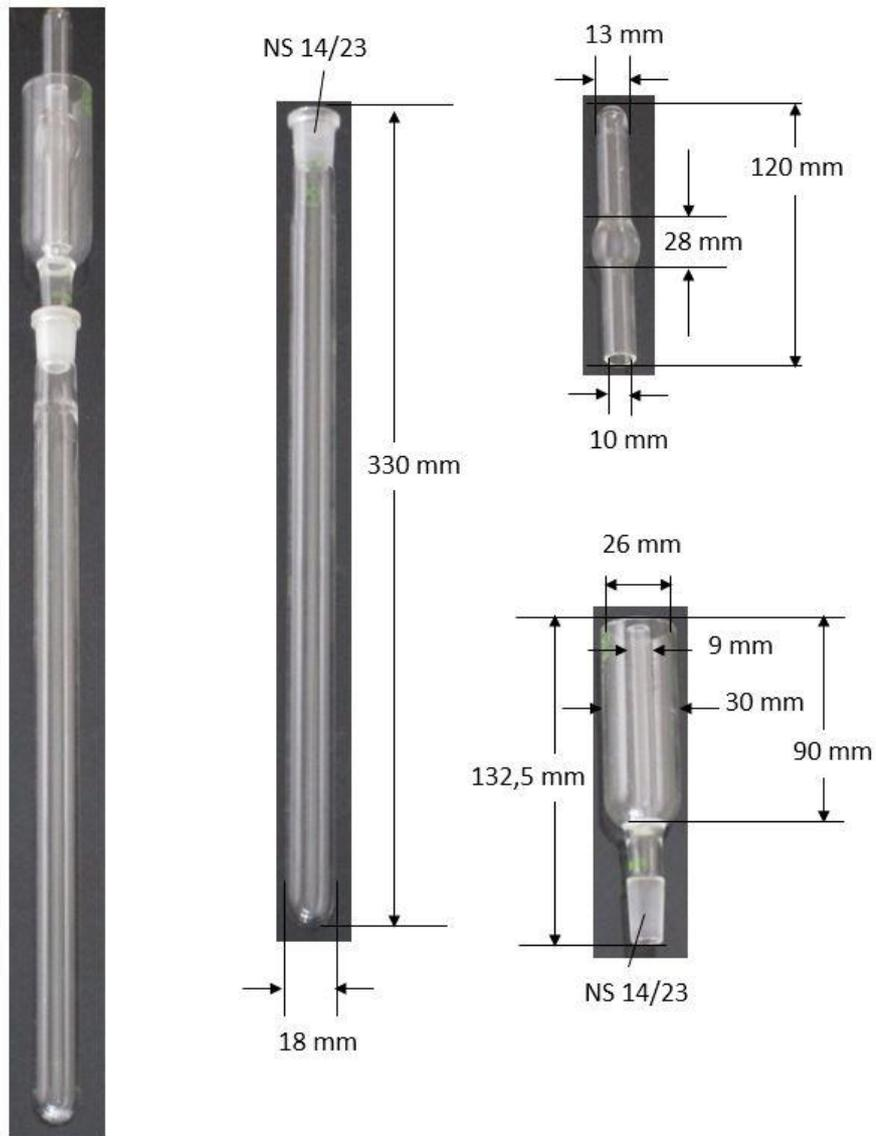
图 A10.2: 用于贝格曼-容克试验的冷凝腔, 示例 2
