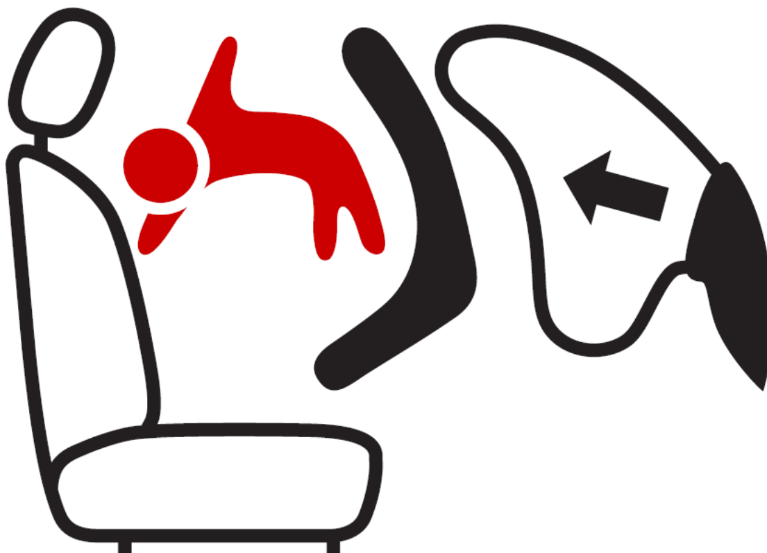
Figure 3 Pictogramme à utiliser pour illustrer le danger en cas de déploiement du coussin gonflable, qui doit mesurer 40 mm de large et 28 mm de haut ou être de dimensions proportionnellement plus grandes
