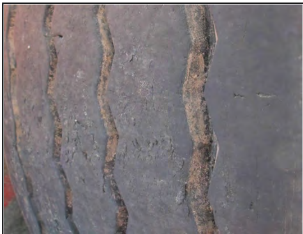
Figure 68 : Abrasion de la bande de roulement du pneumatique 2D
