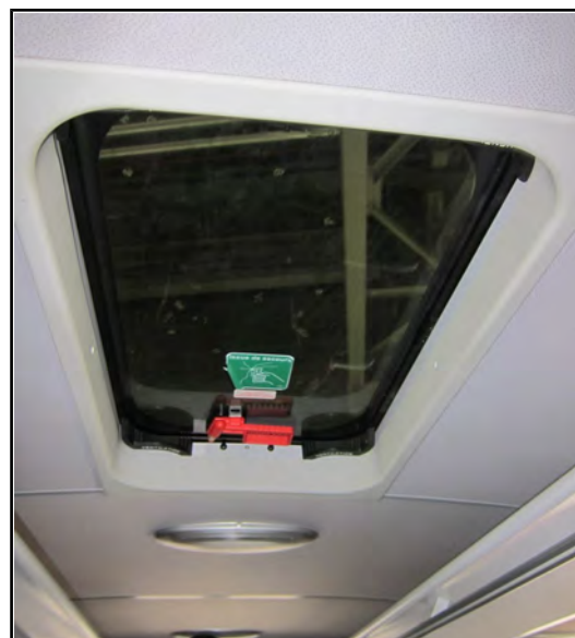
Figure 27 : Vue d'une issue de secours implantée sur le toit d'un autocar similaire à celui impliqué dans l'accident
