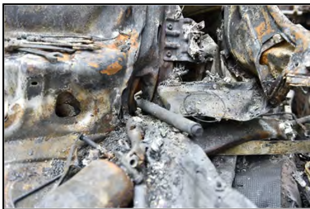
Figure 66 : Vue rapprochée, depuis l'avant du tracteur routier, de la tige métallique ayant perforé l'arrière de sa cabine
