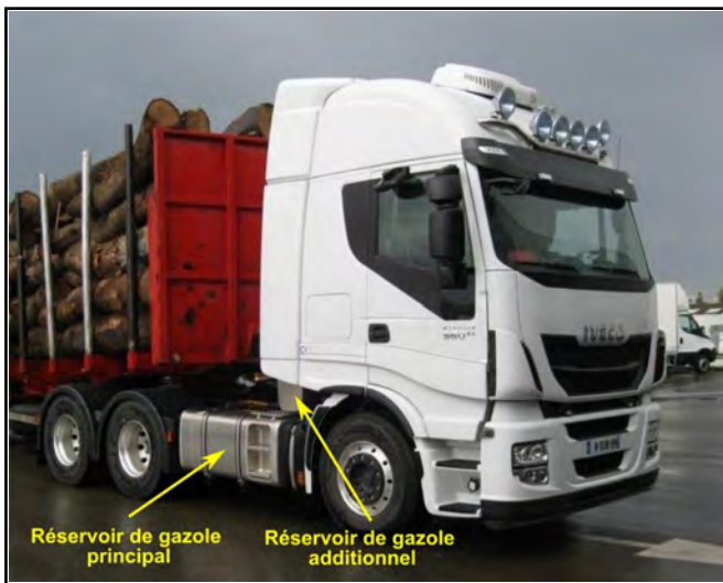
Figure 51 : Vue des réservoirs de carburant équipant le tracteur routier IVECO impliqué dans l'accident
