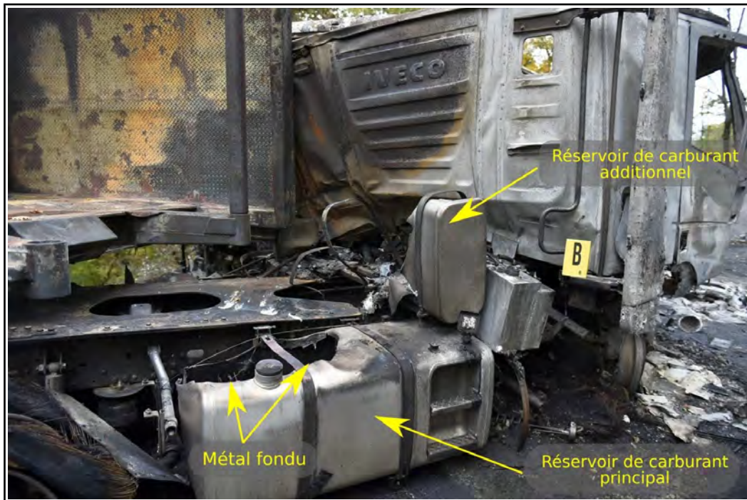
Figure 76 : Vue des réservoirs de gazole du tracteur routier accidenté
