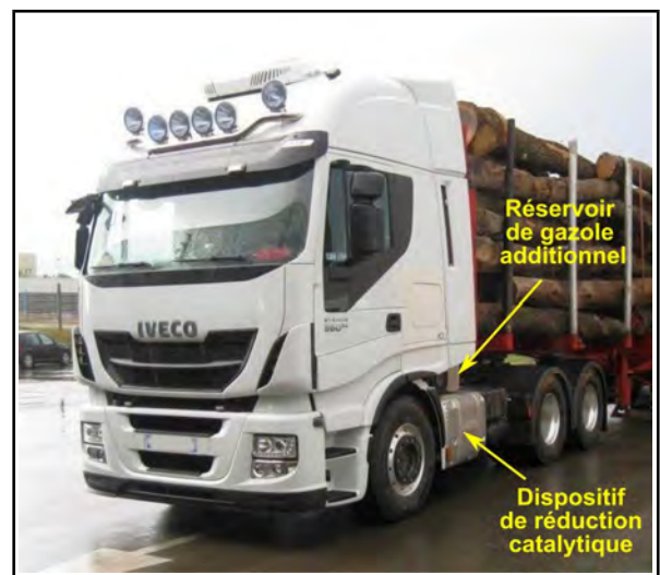
Figure 52 : Vue du réservoir de carburant additionnel du tracteur routier IVECO impliqué dans l'accident
