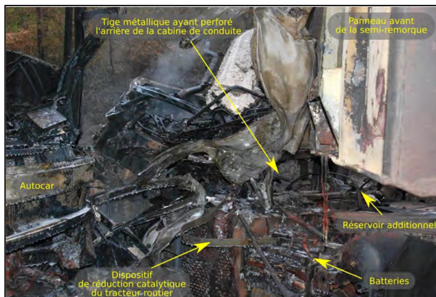
Figure 63 : Vue rapprochée du réservoir additionnel du tracteur routier accidenté
