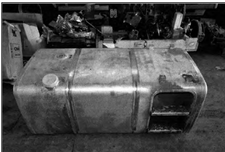
Figure 37 : Vue d'un réservoir similaire au réservoir de carburant principal équipant le tracteur routier IVECO impliqué dans l'accident
