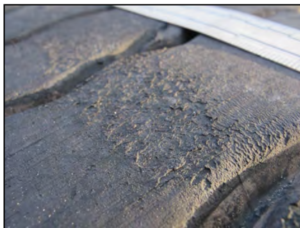
Figure 69 : Abrasion de la bande de roulement du pneumatique 1D
