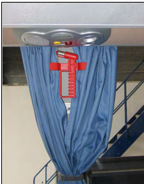
Figure 26 : Vue d'un marteau pic équipant une baie latérale sur un autocar similaire à celui impliqué dans l'accident
