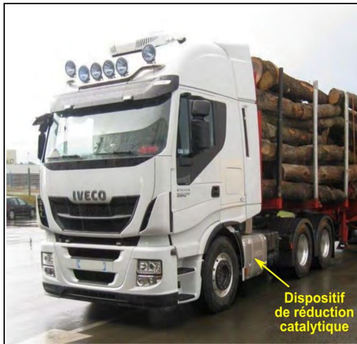
Figure 41 : Vue du dispositif de réduction catalytique du tracteur routier
