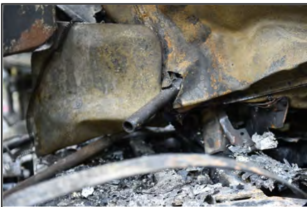
Figure 65 : Vue rapprochée, depuis l'arrière du tracteur routier, de la tige métallique ayant perforé l'arrière de sa cabine
