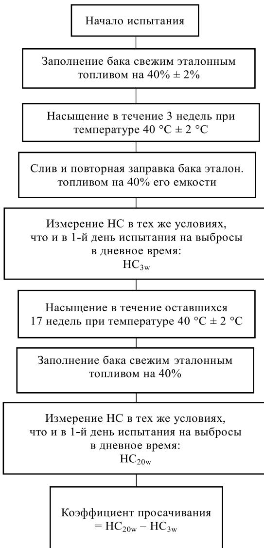
Система топливного бака, являющаяся репрезентативной для всего семейства, отбирается и устанавливается на стенде, а затем подвергается насыщению эталонным топливом в течение 20 недель при температуре 40 °C ± 2 °C. Установка системы топливного бака на стенде аналогична ее установке в транспортном средстве.
