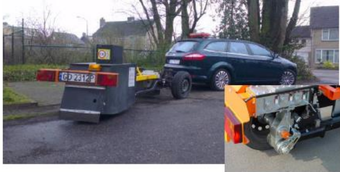
figuur 1 De TU Gdansk trailer voor het uitvoeren van rolweerstandmetingen. De gedetailleerde foto laat de bevestiging van de meetband zien
