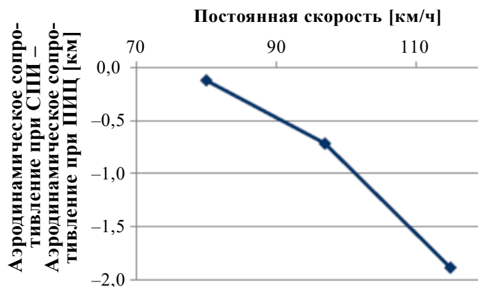
Рис. 26 Данные аттестации сокращенной процедуры испытания, представленные ЕАПАП («БМВ»)
