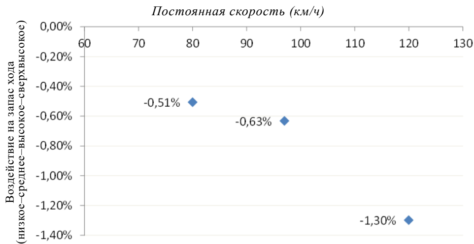
Рис. 25 Данные аттестации сокращенной процедуры испытания, представленные ЕАПАП («Рено»)
