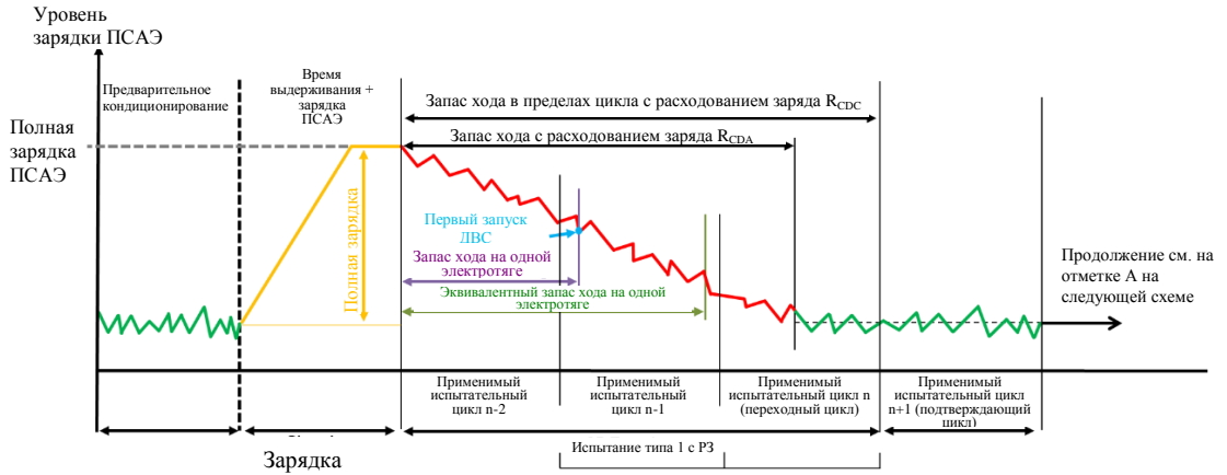
Рис. A8.App1/3 ГЭМ-ВЗУ, испытание типа 1 в режиме расходования заряда с последующим испытанием типа 1 в режиме сохранения заряда
