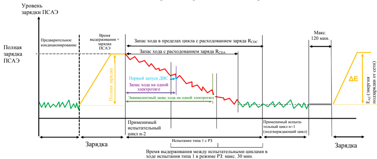
Рис. А8.App1/1 ГЭМ-ВЗУ, испытание типа 1 в режиме расходования заряда
