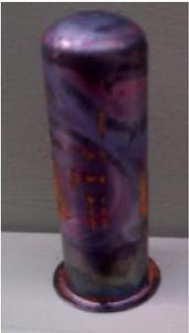
“B”：管底和管壁突出
