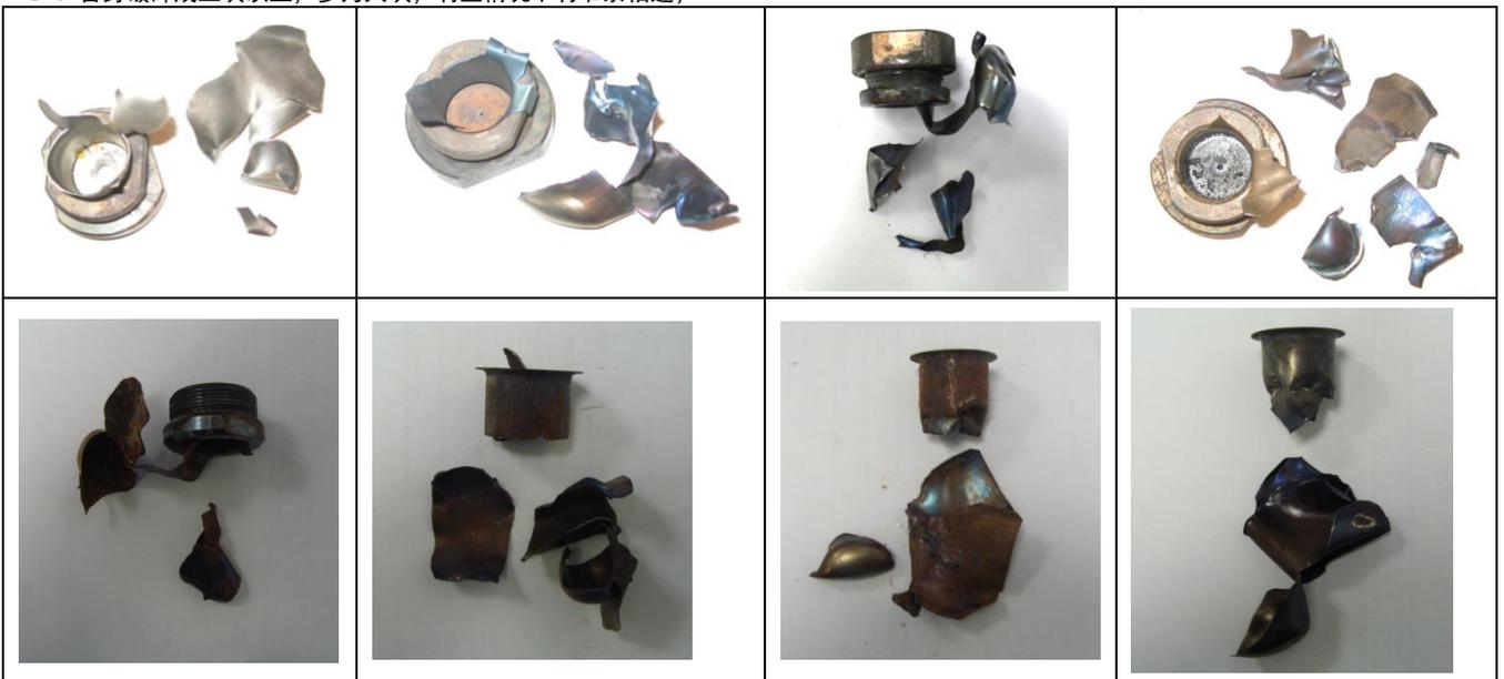
“G”：管身破碎成许多小块，封闭装置损坏
