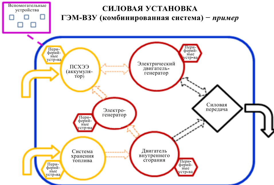
Рис. 6 Гибридный электромобиль – зарядка с помощью внешнего зарядного устройства (комбинированная система) – ГЭМ-ВЗУ
