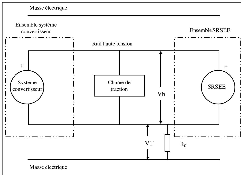
Si V2 est supérieure à V1, insérer une résistance normalisée connue (Ro) entre le pôle positif du rail haute tension et la masse électrique. La résistance Ro étant en place, mesurer la tension (V2') entre le pôle positif du rail haute tension et la masse électrique (voir fig. 3). Calculer l'isolement électrique (Ri) conformément à la formule indiquée. Diviser cette valeur d'isolement électrique (en Ω) par la tension de fonctionnement nominale du rail haute tension (en V).
