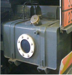
Sur ce type de moyens de rétention, les soudures sont des soudures d'angles pour lesquelles le CND par radiographie ou par ultrason ne donne aucun résultat probant.
