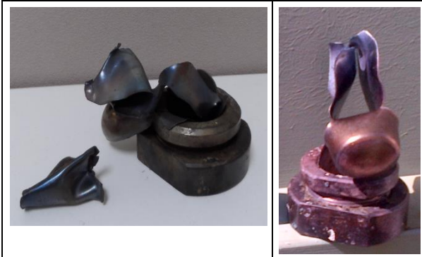
“F”: Tubo fragmentado en tres o más trozos, generalmente grandes, que en algunos casos pueden estar unidos entre sí por una tira estrecha de material;
