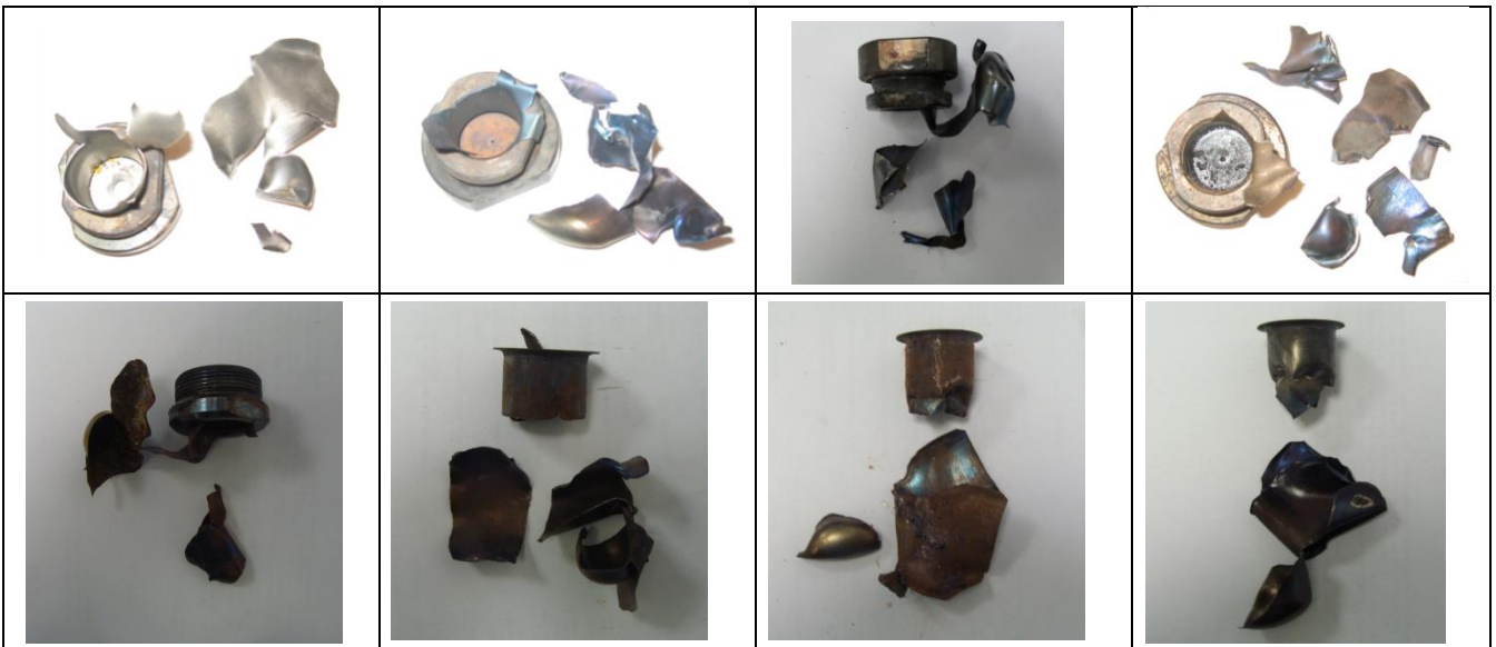
“G”: Tubo fragmentado en muchos trozos, generalmente más pequeños, con el dispositivo de cierre intacto
