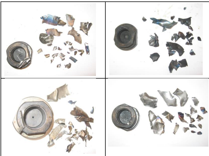
“G”: Tubo fragmentado en muchos trozos, generalmente más pequeños, con el dispositivo de cierre intacto
