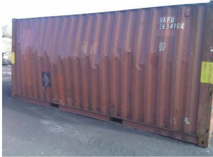
Рис. 1: Закрытый контейнер, поврежденный в результате повышения давления под влиянием шлаковых отходов.
