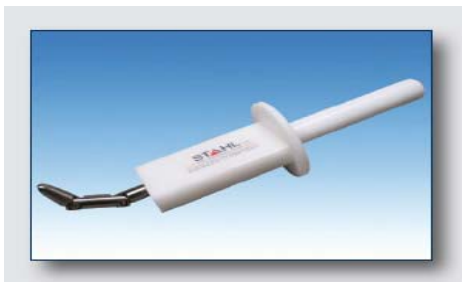
Figure 6 Doigt d'épreuve normalisé
