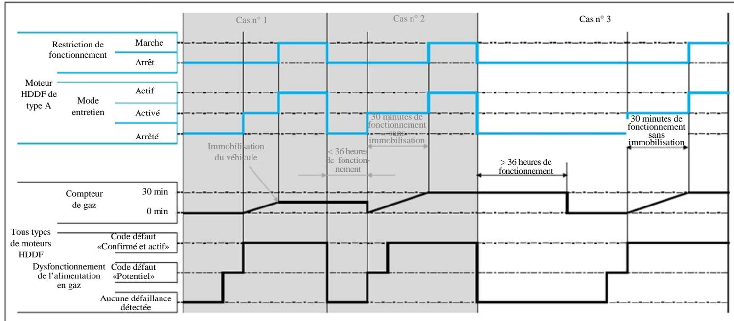
Après 36 h de fonctionnement sans détection d'un défaut de fonctionnement du système d'alimentation en gaz, le compteur est remis à zéro (voir par. A.2.1.2.3.2.1).
