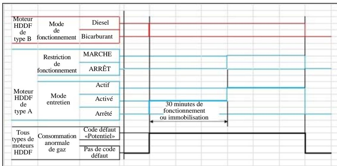
Dans ce cas, le mode service est activé (dans le cas d'un moteur HDDF de type A) ou le moteur passe en mode diesel (dans le cas d'un moteur HDDF de type B), dès que le code défaut devient "Potentiel" (première détection).
