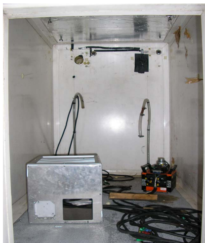
Калориметр для испытания установки на сжиженном газе
