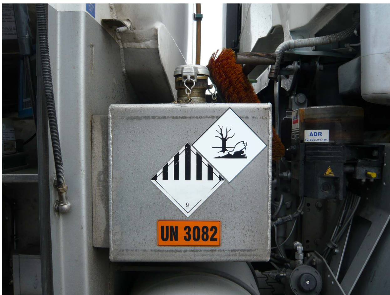
Иллюстрация: современная система добавления присадок, установленная в системе подачи печного топлива, содержащегося в автоцистерне
