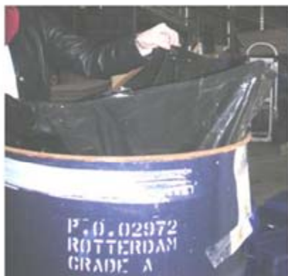
Пластиковый пакет, используемый в настоящее время (перед заполнением) Пакет выступает примерно на 20 см над верхней кромкой барабана
