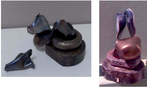
"F": Douille fragmentée en trois morceaux ou plus, assez gros pour la plupart, éventuellement restés attachés entre eux
