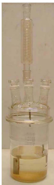
Figure 37.4.2.2: RÉACTEUR AVEC RÉFRIGÉRANT À REFLUX
