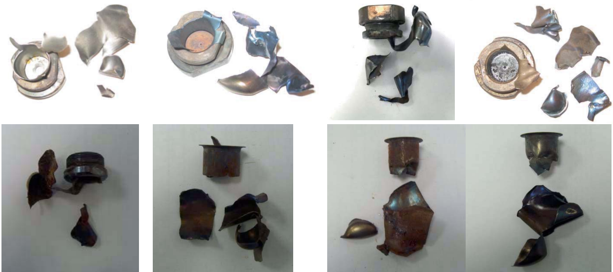
"G": Douille fragmentée en de nombreux morceaux, petits pour la plupart, dispositif de fermeture intact
