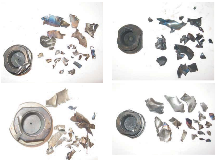
"G": Douille fragmentée en de nombreux morceaux, petits pour la plupart, dispositif de fermeture intact
