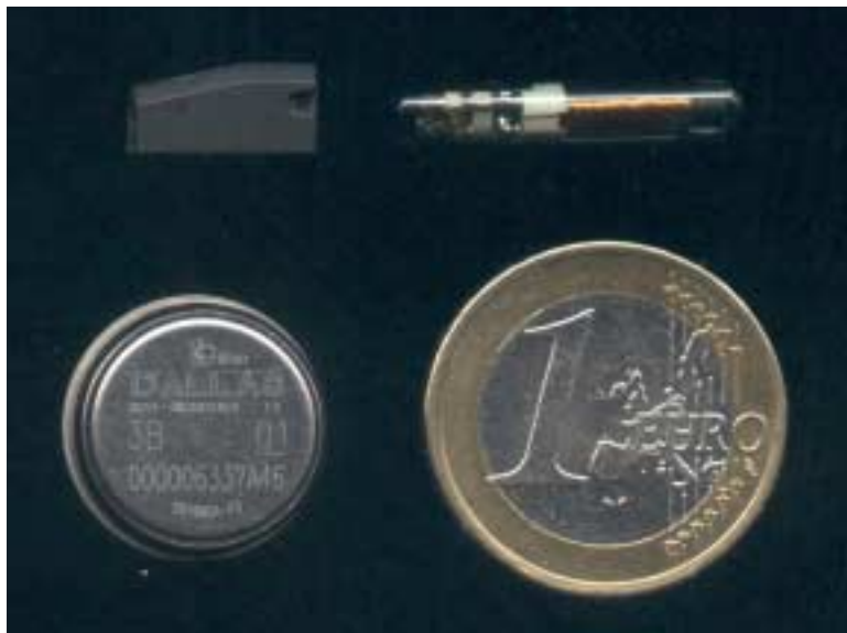
Figure 11. Deux transpondeurs passifs à fréquences radioélectriques commerciaux (en haut de la figure) et un dispositif à mémoire par contact (en bas à gauche). Les transpondeurs n'ont pas besoin de piles car ils se chargent en électricité au moment de la lecture. Ils communiquent ensuite un seul numéro de série au lecteur (le lecteur se trouve habituellement à quelques centimètres des transpondeurs à fréquences radioélectriques mais le iButton doit être en contact). Ce n'est pas en ajoutant inconsidérément de tels dispositifs à des scellés passifs que l'on augmentera les chances de détecter les effractions et il se pourrait même que le contraire se produise.
