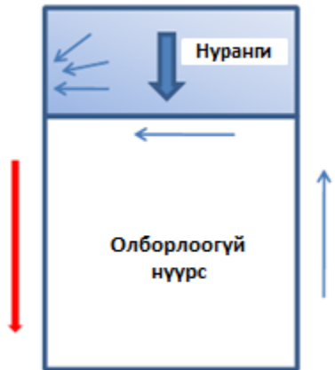
Диаграм 4.3: Олборлолт Хийгдэж буй Хийтэй Нүүрсний Тууш Биетийн Мөргөцөгүүдэд Ашигласан Агааржуулалтын Схемүүд
