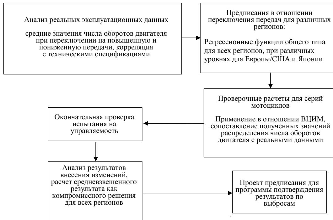
Рисунок 17: Схема разработки предписания в отношении переключения передач
