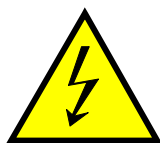
Рис. 1 Маркировка высоковольтного оборудования
