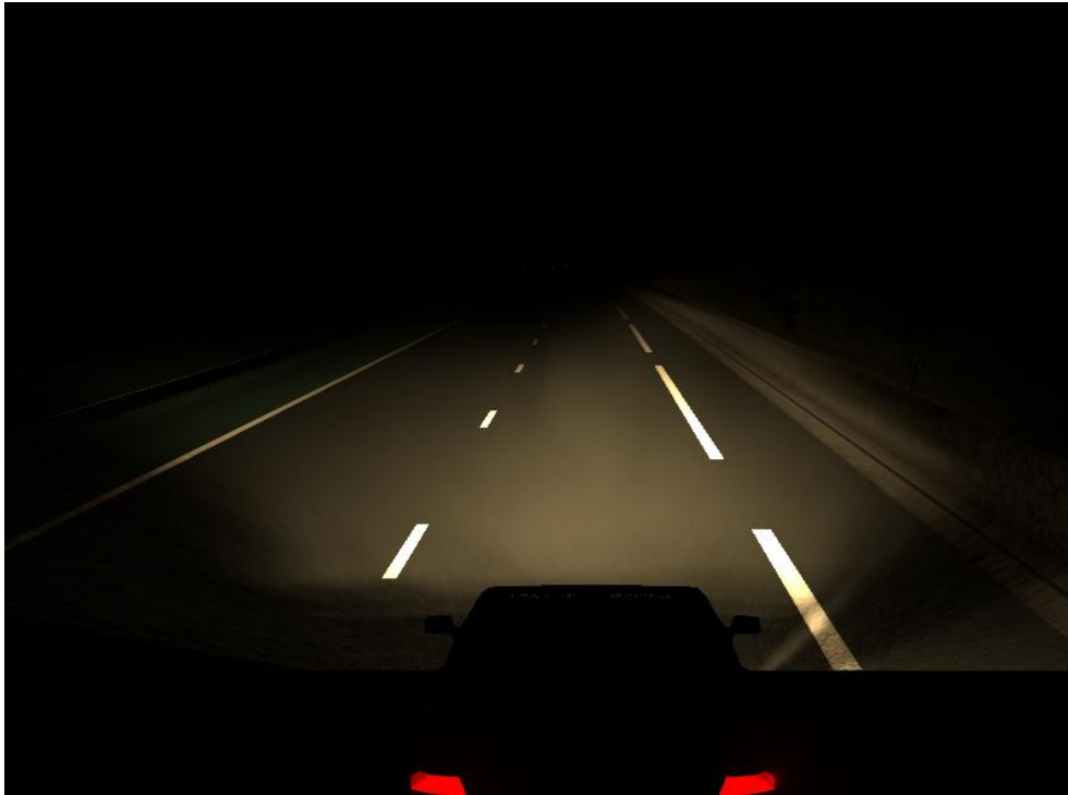
Figure 3. Aspect visuel d'un faisceau de croisement produisant un flux lumineux de 140 lumens dans la Zone I
