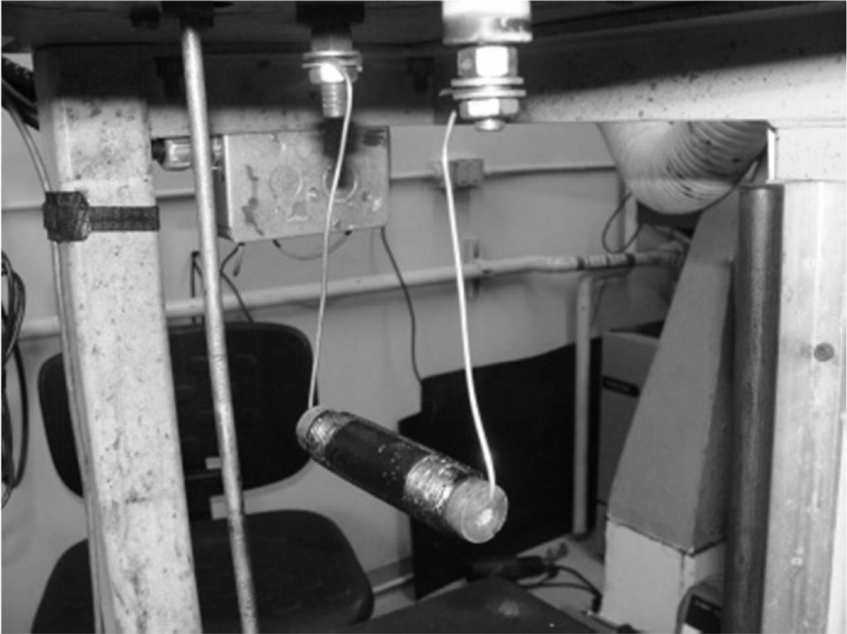
Figure 2 Cellule d'essai montée horizontalement sous le capot de la pompe (conducteurs en cuivre reliés aux électrodes fixes de la pompe)
