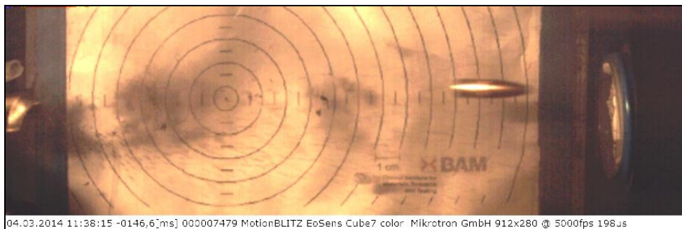
Figure 2 Projectile ayant parcouru le fond gradué à t = 3,2 ms
