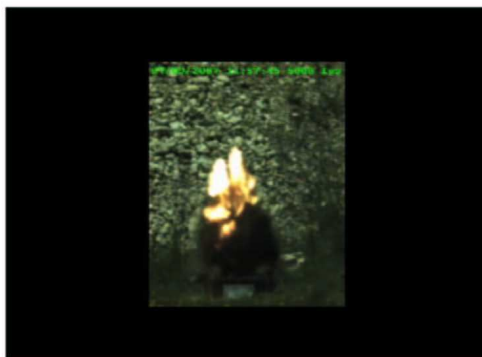
Jet de flamme produit par des perforateurs à charges creuses de 20 g de RDX
