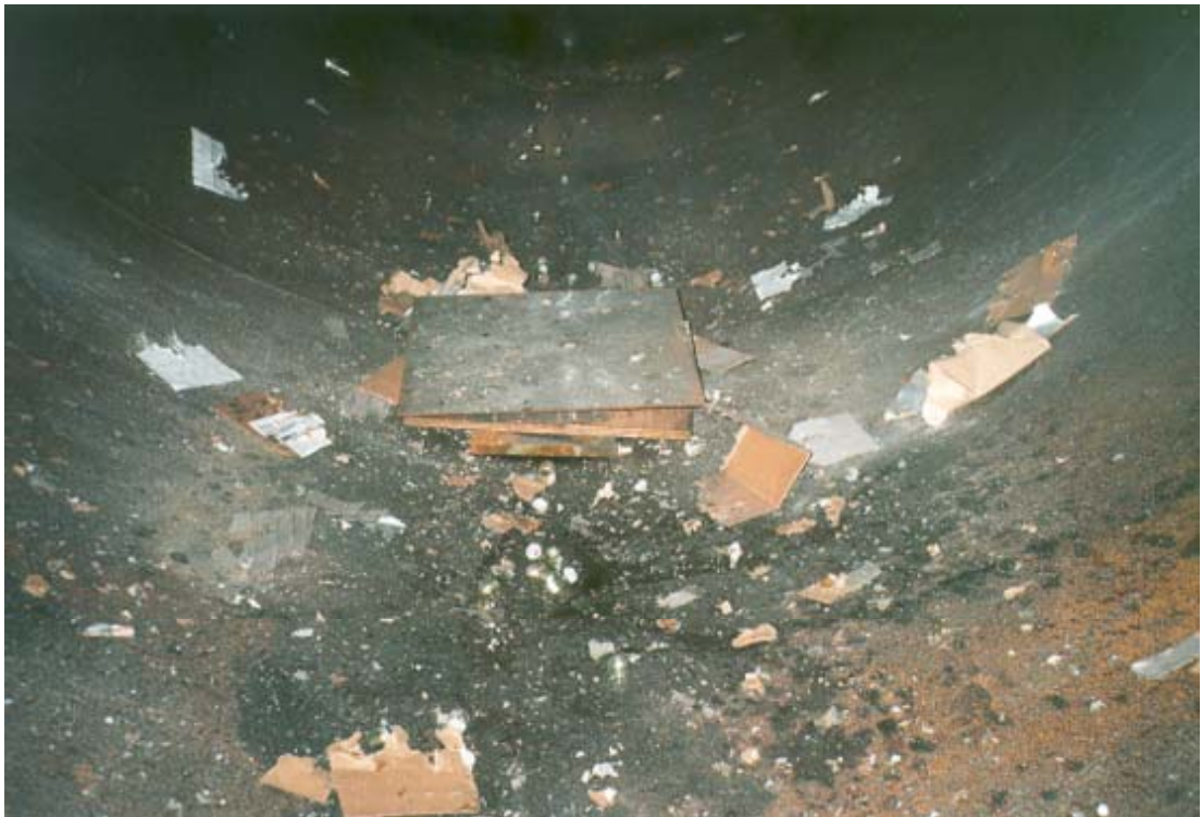
Figure 2 – Débris après la mise à feu
