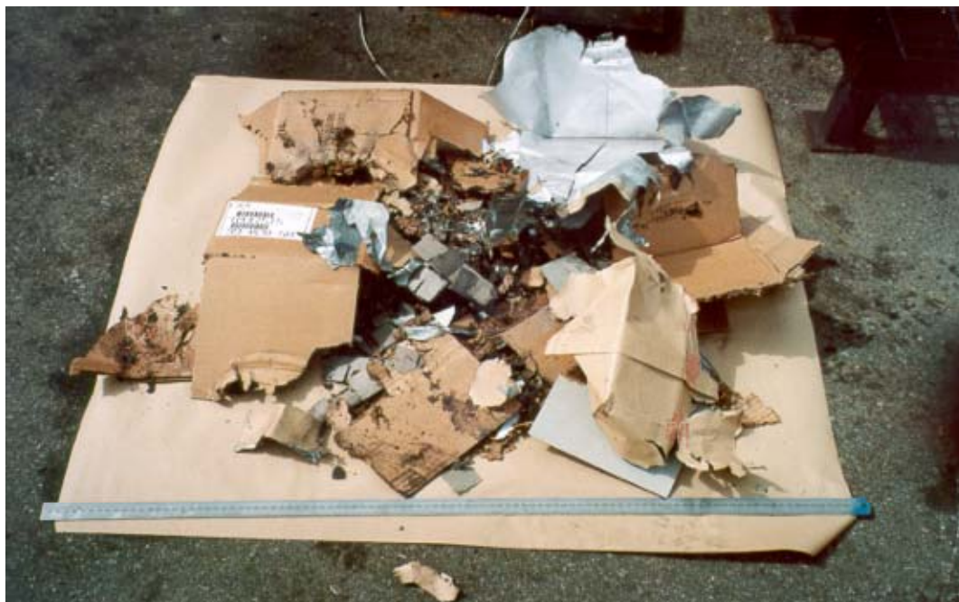
Figure 4 – Perforation de l'écran-témoin en acier
