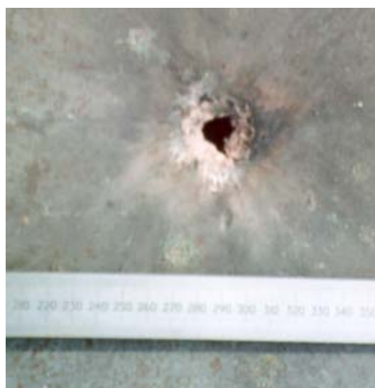
Figure 4 – Perforation de l'écran-témoin en acier
